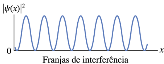
Posições de incidência de elétrons no detector
